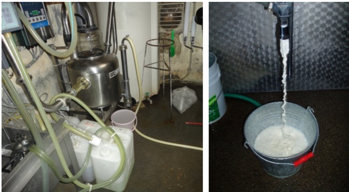
図4 ミルクパイプの残乳回収状況
